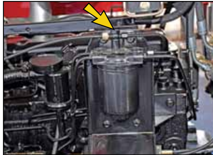
شکل ۲۳: پیچ هواگیری فیلتر گازوئیل
