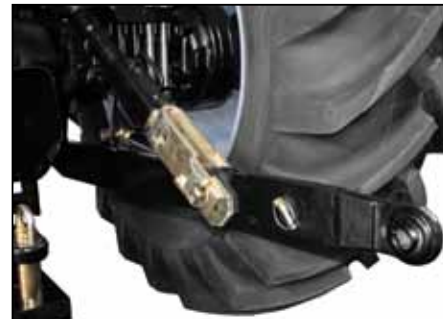
شکل ۱۴: حالت شناور محورهای تنظیم
