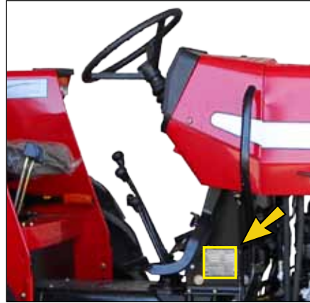
شکل ۱: محل پلاک شماره سریال تراکتور
