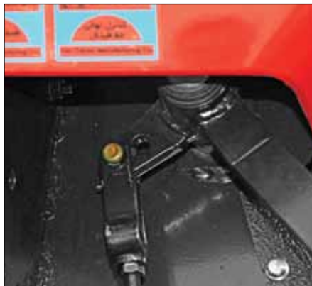
شکل ۳۷: اتصالات بالایی پدال کلاچ
