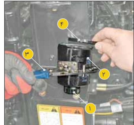
شکل ۲۲: نحوه تعویض فیلتر سوخت
