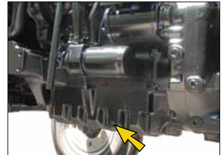
شکل ۱۸: درپوش تخلیه روغن موتور
