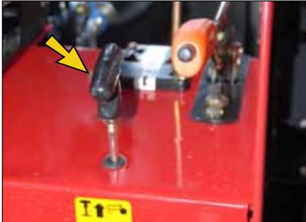
شکل ۴: اهرم درگیر کننده محور جلو
