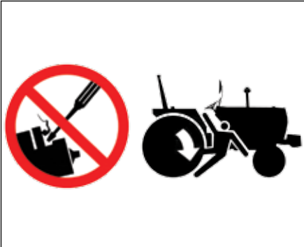
شکل ۲۱: استارت زدن غلط
