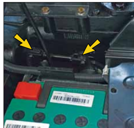
شکل ۳۶: اتصالات پایینی پدال کلاچ
