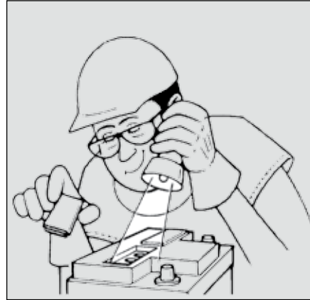
شکل ۱۲: کنترل سطح آب باطری
