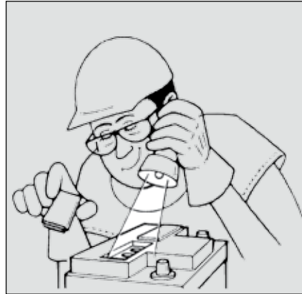
شکل ۱۲: کنترل سطح آب باتری
